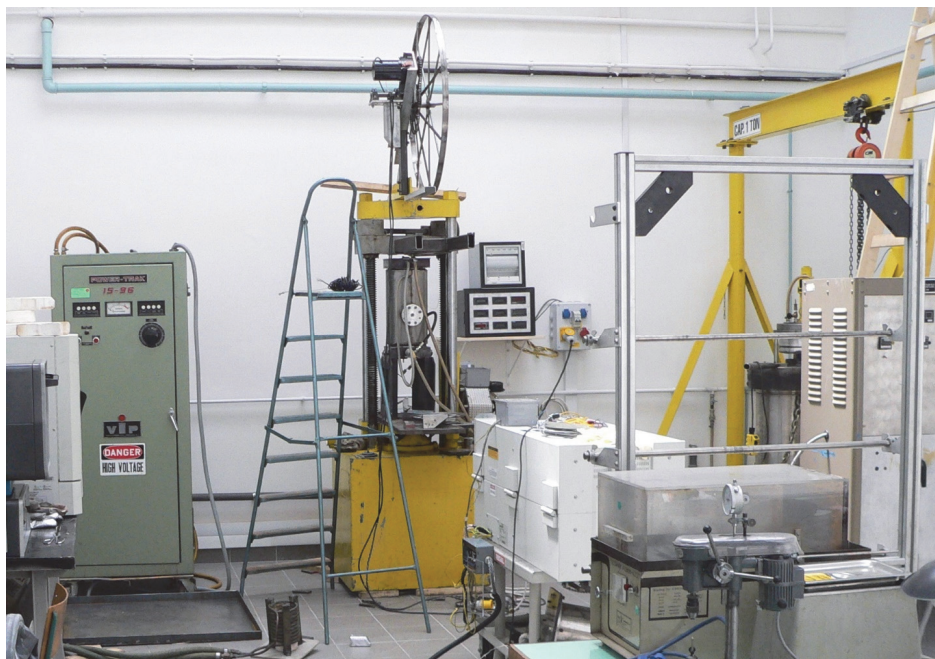
5. ábra – A Bostonból Budapestre került kemencék 2005-ben, a laboratórium berendezései; a Blücher-kemencék acélszerkezete sárga színű. A vákuumozható, nyomásos besajtolókemence a képen jobbra, hátul található. A kép középső részét tölti ki a folyamatos huzalgyártó kemence
