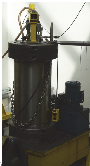
4. ábra – A bostoni NEU-ról Budapestre került, nagyméretű tömbök előállítására alkalmas besajtolókemence kemence fényképe (a) és az azt 2022-ben éppen lezáró gyártója, Blücher József
