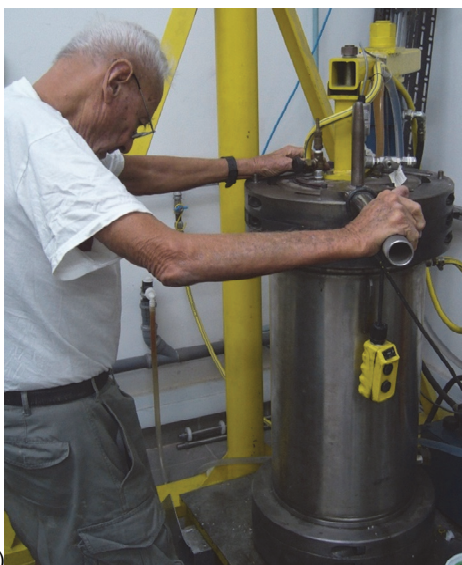
4. ábra – A bostoni NEU-ról Budapestre került, nagyméretű tömbök előállítására alkalmas besajtolókemence kemence fényképe (a) és az azt 2022-ben éppen lezáró gyártója, Blücher József
